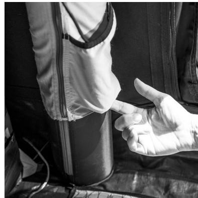
16. Åbning til opladningskabel i bunden af lommerne til lysenheder.
